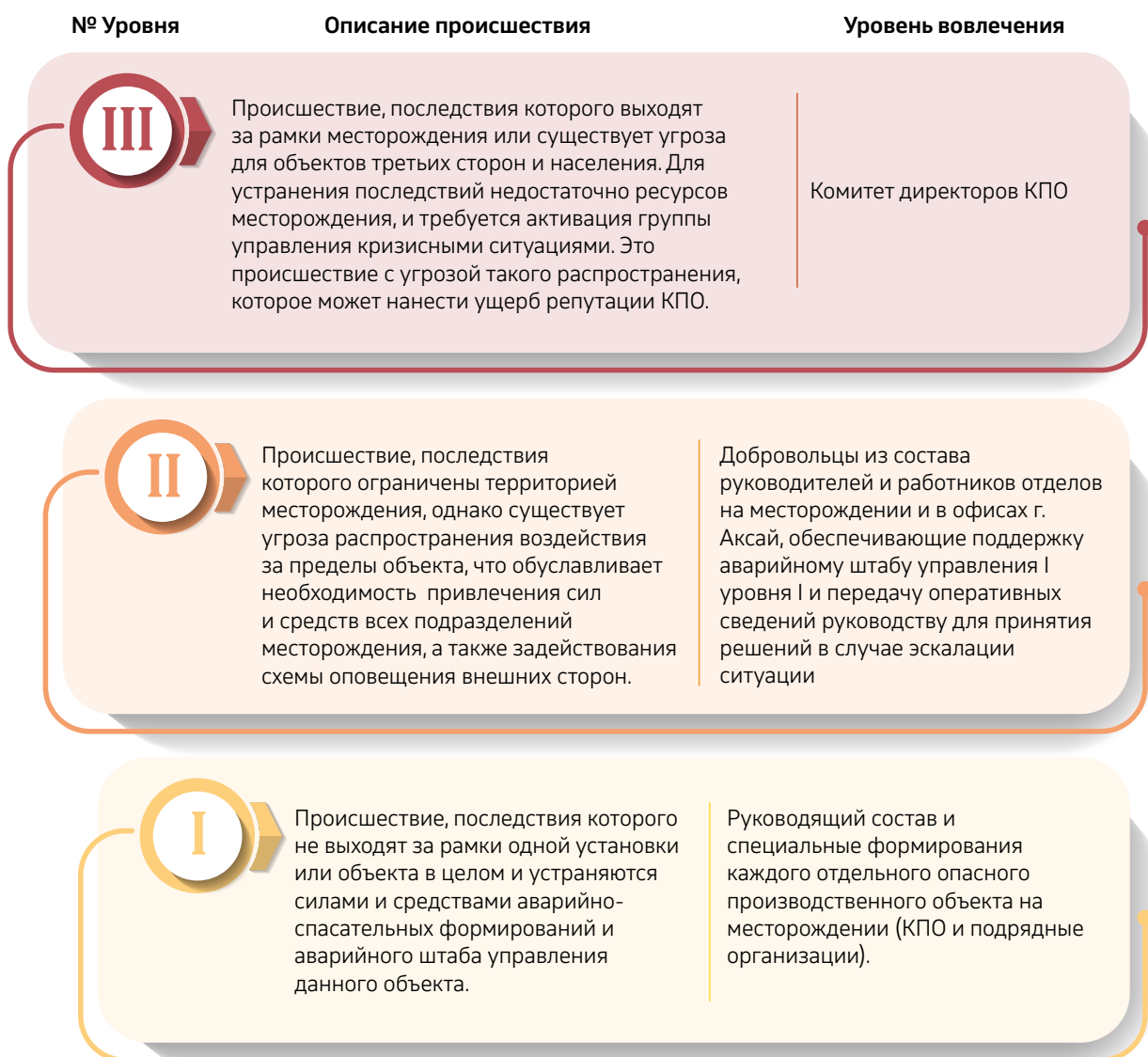
Рис. 6. Система аварийного реагирования КПО GRI 3-3, 403-5
