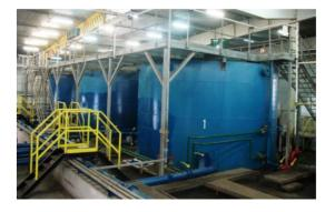
Буровые растворы, используемые для бурения, завершения и ремонтных работ, готовятся на заводе по приготовлению буровых растворов.
